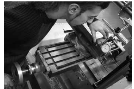
Beispiele aus der beruflichen Praxis: Überprüfen von Druckbogen (ganz oben), Ausrichten eines Schraubstocks mit der Messuhr (oben).
