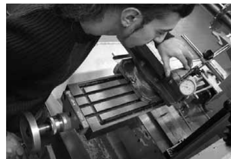
Beispiele aus der beruflichen Praxis: Überprüfen von Druckbogen (ganz oben), Ausrichten eines Schraubstocks mit der Messuhr (oben).
