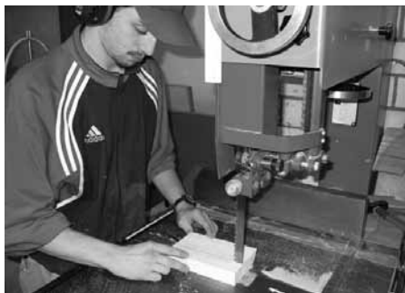
Beispiele für Werkzeugsteuerung: Umbügeln einer Blende (ganz oben); mit der Bandsäge auf Anriss sägen (oben).
